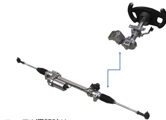
マニュアル運転時は、ステアリングホイールの回転角をセンサで検知し、転舵アクチュエーターに電気信号を送り制御
