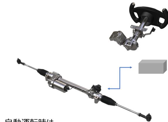
自動運転時は、自動運転ECUから転舵アクチュエーターに電気信号を送り制御
